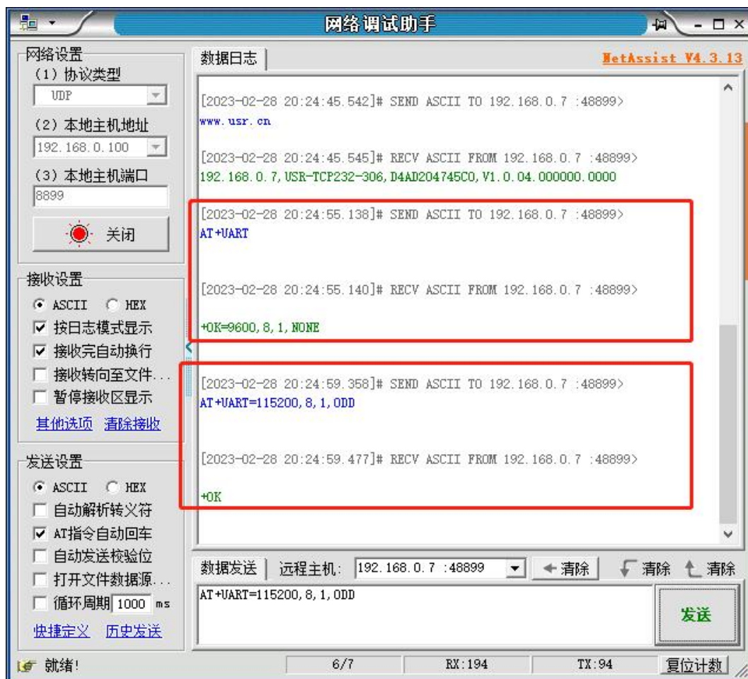
图 3 网络 AT 指令设置和查询
